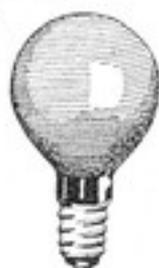
S 7/1515 Beleuchtungsbirnen mit Kleinedisongewinde 10 W. lieferbar in 110, 125 und 150 Volt aus Restposten. Für Schallplattenbeleuchtung, Nähmaschinenbeleuchtung, Toilettenkleinbeleuchtung. Zwei 110 Volt Birnen lassen sich auch einfach zu 220 Volt zusammen schalten. Preis ohne Sockel **0,25**
