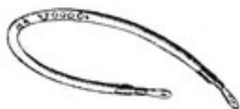
S 7/3611 4 Watt Spaghettihelliegen, besonders konstant, da drahtgewickelt und gute Wärmeableitung, da 20 cm lang und 5 mm ø, 100 Ohm (braun), 5000 Ohm (violett), 10 000 Ohm (weiß), 50 000 Ohm (grün)
